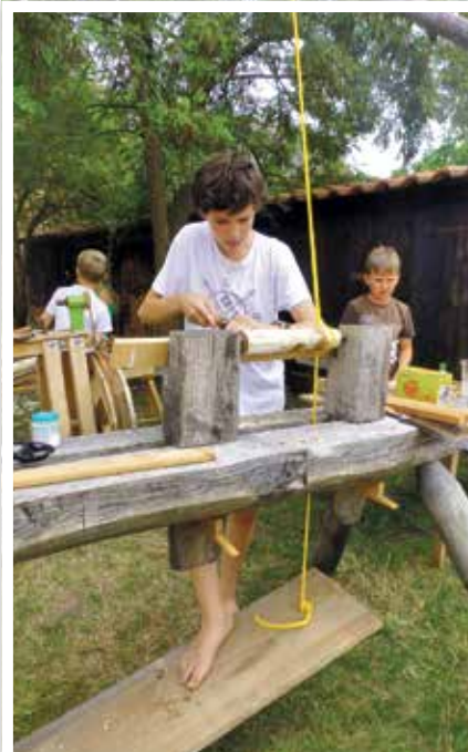
Peter beim Drechseln an der Wippdrehbank
